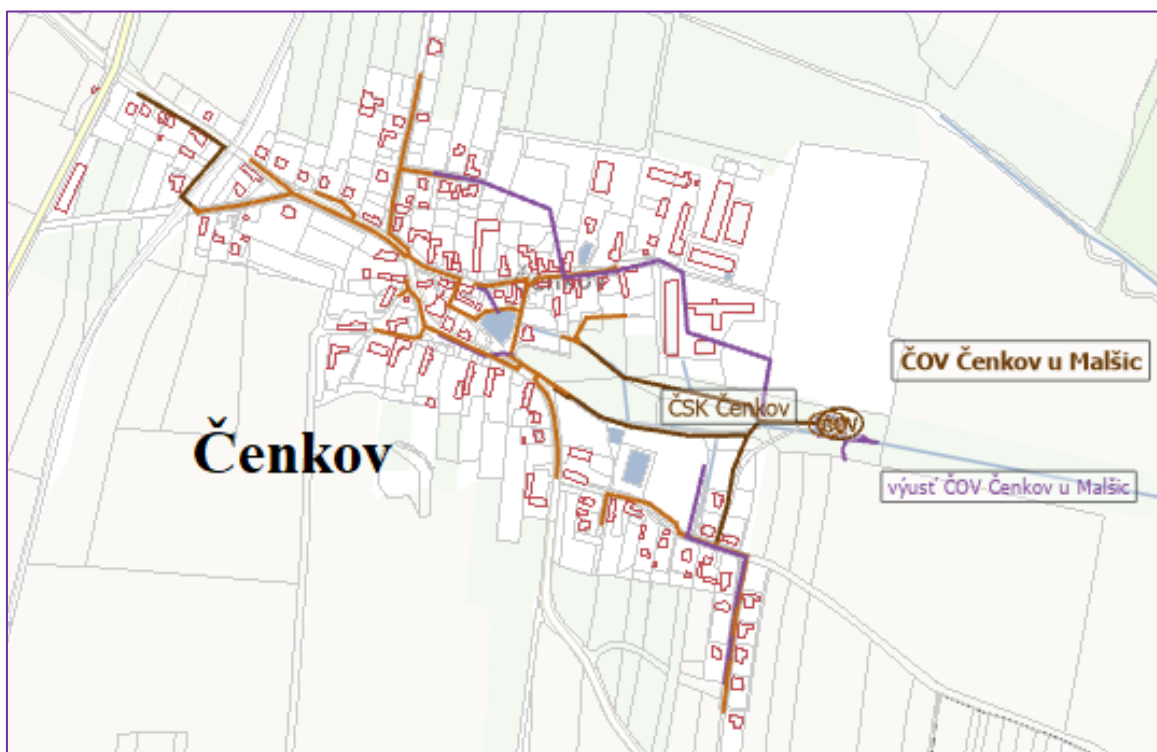
Orientační schéma kanalizační sítě části Čenkov
